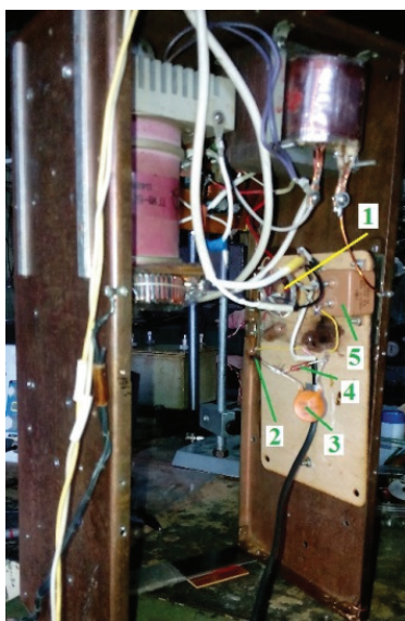
Рис. 6. Коммутатор импульсный тиратрон ТГИ1-500/16 и плата управления тиратроном в собранном виде Pic. 6. TGI1-500/16 impulse modulator thyatron and the control board, assembled
